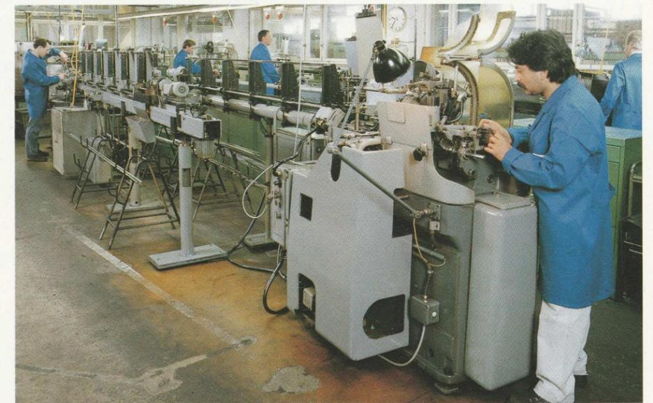
*In der Dreherei werden auf kurvengesteuerten Revolverdrehautomaten, Langdrehautomaten und Kopierdrehmaschinen Walzenkerne, Wellen und Achsen mit einem Höchstmaß an Genauigkeit gefertigt.*
