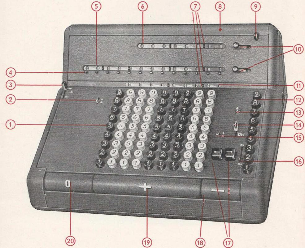
Im Zuge der Weiterentwicklung erfolgte die Teilung der Nulltaste (20) und Zuordnung der Taste (21) für automatische Rückführung und Löschung des Zählwerkschlittens.
