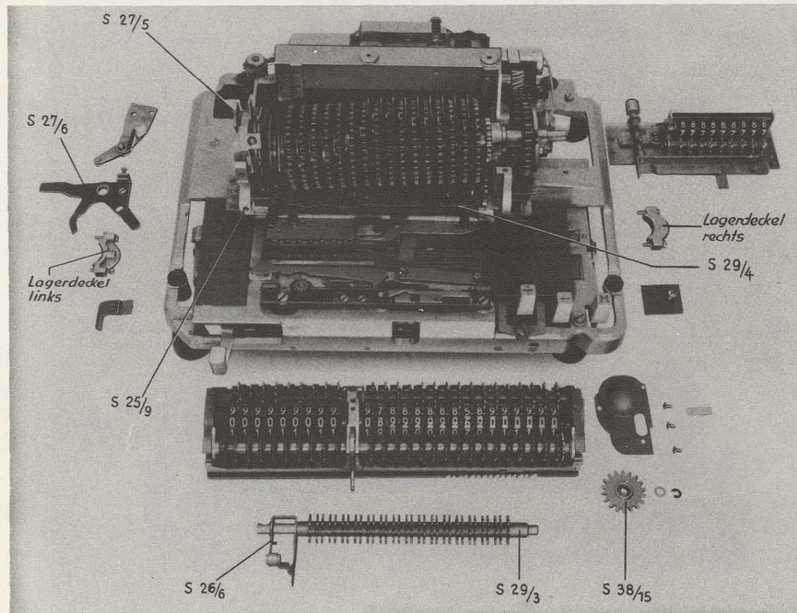
Kontrollwerk abnehmen (siehe hierzu die betreffende Erläuterung). Die an der linken Seite des Systemlagerbocks mit 2 Schrauben befestigte Flanschachse (S 27/5) nach Entfernung der beiden Befestigungsschrauben und des vor dem Transportsicherungshebel (S 27/6) befindlichen Sprengringes so weit herausziehen, bis der Transportsicherungshebel frei ist.
