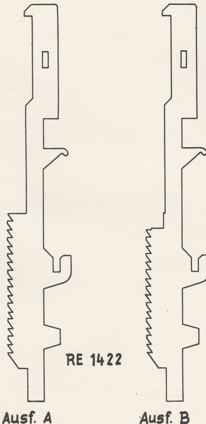
Der hierbei gleichzeitig in das Systemrad wieder eingreifende Sperrzahn des Sicherungshebels bringt dieses vor der Arretierung noch in die endgültige Stellung.
