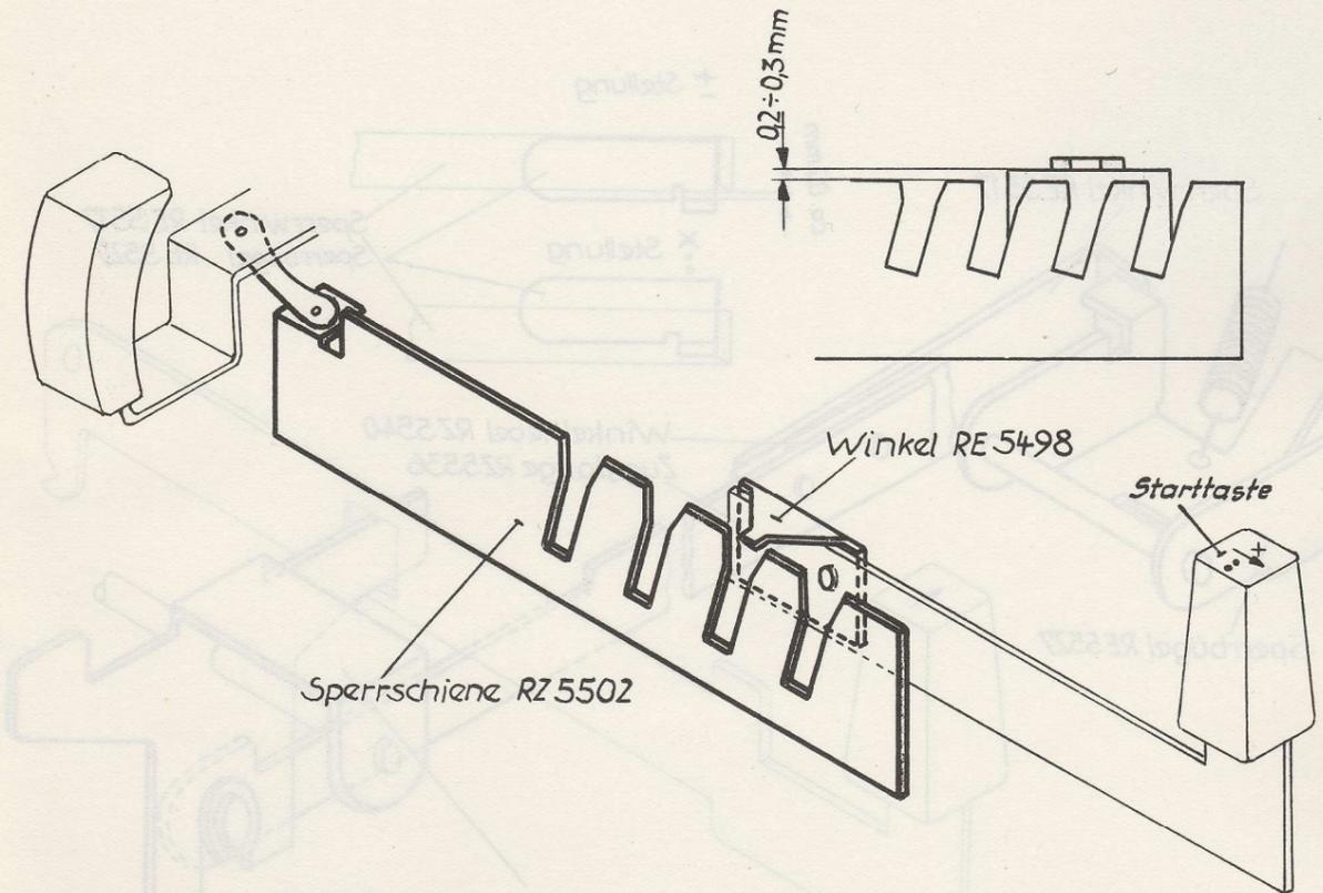
*Die Sperre arbeitet wechselseitig zwischen Umschalthebel und Starttaste. Sie verhindert den Start zur Multiplikation und Division, wenn der Umschalthebel nicht korrekt eingerastet ist. Sie verhindert weiterhin ein Schalten des Umschalthebels, wenn die Starttaste gedrückt ist.
