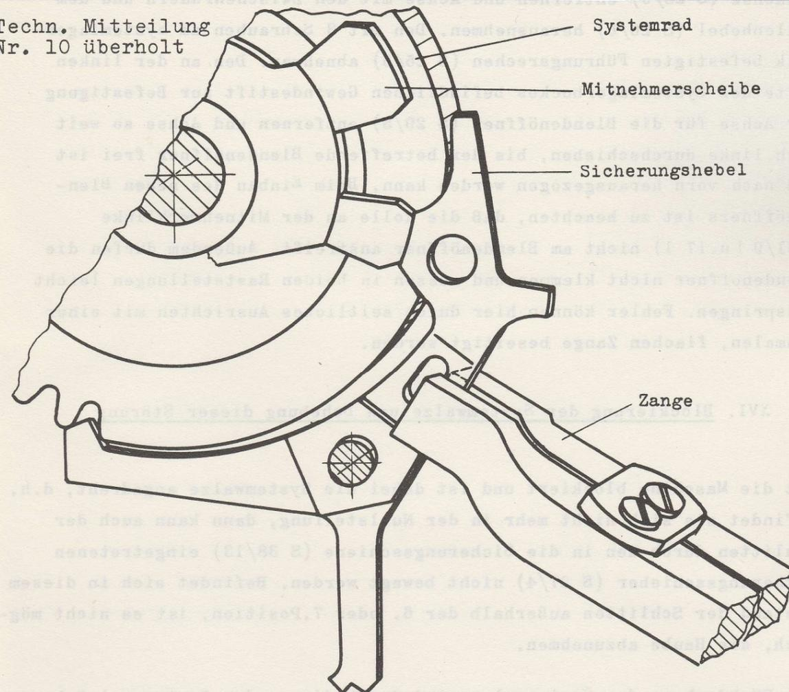
Für das Anpassen der Sicherungshebel in unseren Rechenmaschinen wurde eine Spezialzange entwickelt. Mit Hilfe dieser Zange kann der Sicherungshebel in der Maschine durch Drücken des Schenkels, der die Sperrkurve hat, zum Sperrnocken des Systems angepaßt werden. (Bekanntlich darf der Spielraum zwischen Sperrnocken und Kurve maximal nur 0,1 betragen.)
