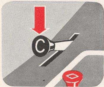
Steht der «Plus-Minus»-Hebel bei einem Negativprodukt auf Plus (+), bleiben die Total- und Sub-Total-Taste gesperrt und können erst wieder gedrückt werden, nachdem der Hebel auf Minus (-) umgestellt worden ist.
