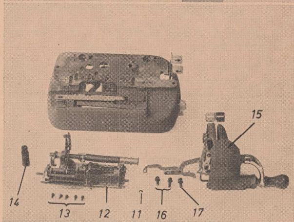
Nachdem die Maschine wieder aufgerichtet wurde, sind nun die mit 10 Rundkopfschrauben befestigten Ziffern- und Rückenbleche abzunehmen.
